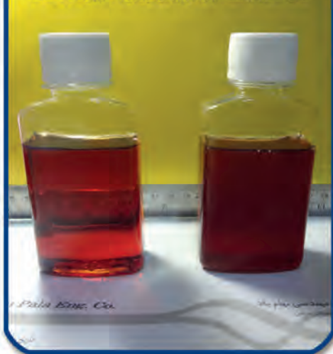
نتایج حاصل از تصفیه وارنیش روغن توربین با فناوری ESVR
